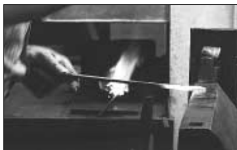
Vormaterialerwärmung bis Weissglut
