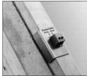
Bohrschablone für Sparrennägel
