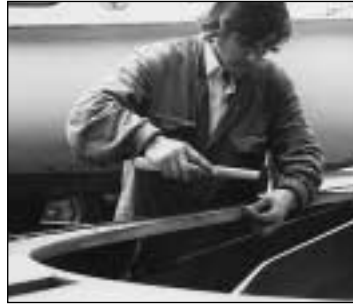
Anbringung gebogener Deckleisten beim Bootsbau
