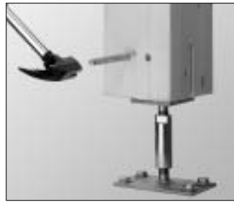
Pfostenträger Typ »T«, hoher konstruktiver Holzschutz, da keine außenliegenden Metallteile
