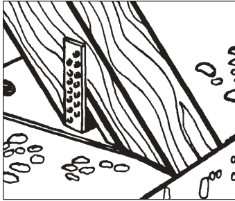
Fußpunkt: Sparren auf Beton ohne Überstand
