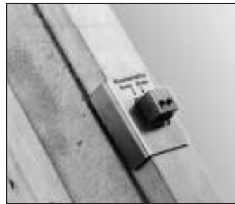
Bohrschablone für Sparrennägel
