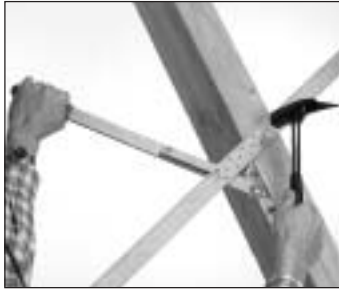
Rispenband-Spanngerät Typ »RS«
